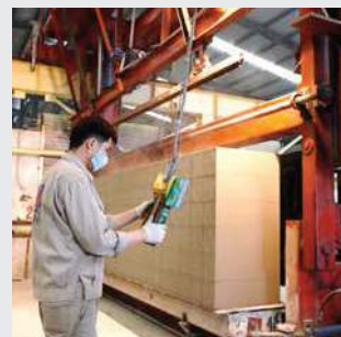
Hệ thống cầu lật
